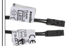
A.1 Etiketten der defekten Lampe
